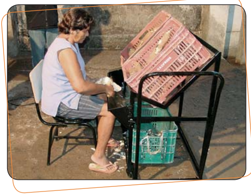
Figura 4 – Descascadeira de raízes de mandioca na estação de trabalho
