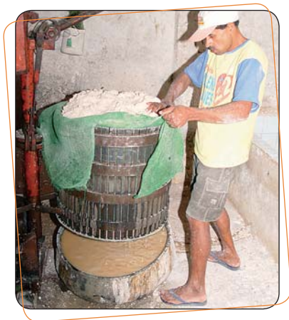
Figura 7 – Prensa hidráulica em operação
