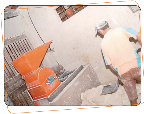
Figura 8 – Triturador de massa prensada em operação
